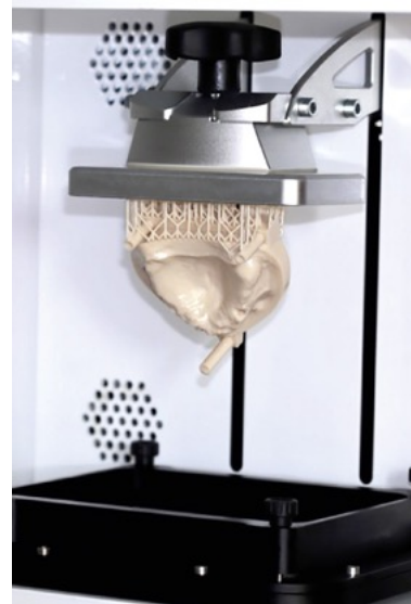
➤ 6 Die 3D-gedruckten Arbeitsmodell
